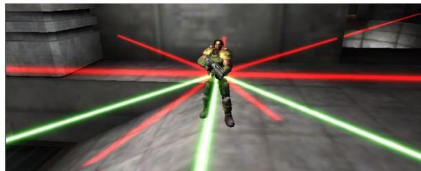
Abbildung 21: 10 Strahlen zur Abtastung der Umgebung des Agenten. Grün: nicht kollidierende Strahlen; rot: kollidierende Strahlen.
